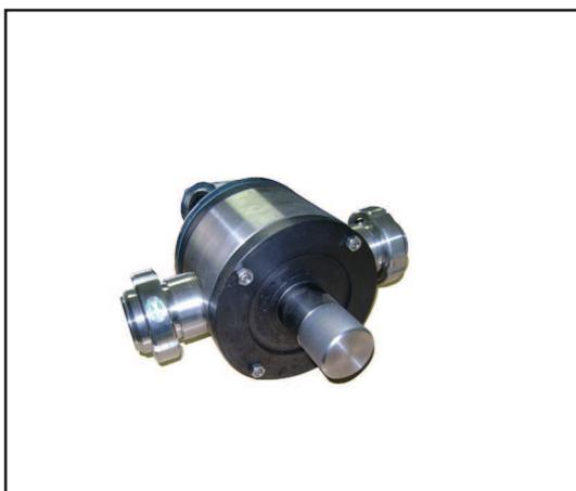
Bomba SBP - 500 a paletas, construída en acero inoxidable y PTFE conexiones Danesas 2\"/>
